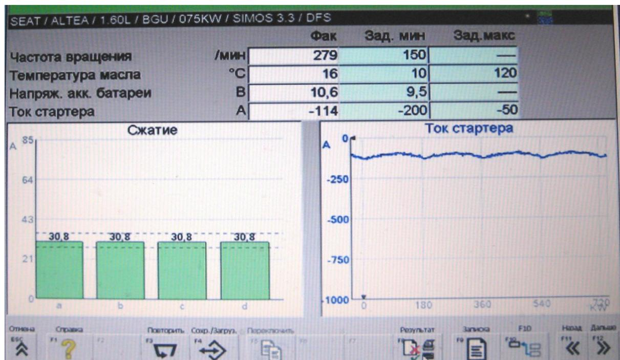
Рис. 4. Гистограммы относительной компрессии в цилиндрах
